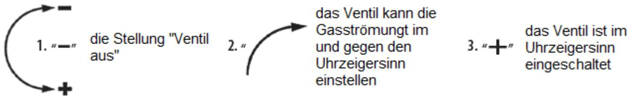
**Beachten Sie, dass das Ventil von der " - " aus gegen den Uhrzeigersinn aufgedreht wird. Stellen Sie die Gasströmung immer gleichmäßig ein, indem Sie das Ventil gegen den Uhrzeigersinn drehen, bevor Sie den Drehwinkel beenden. Nach dem Gebrauch drehen Sie das Ventil auf " - " und lassen Sie die Gaskartusche los.**
